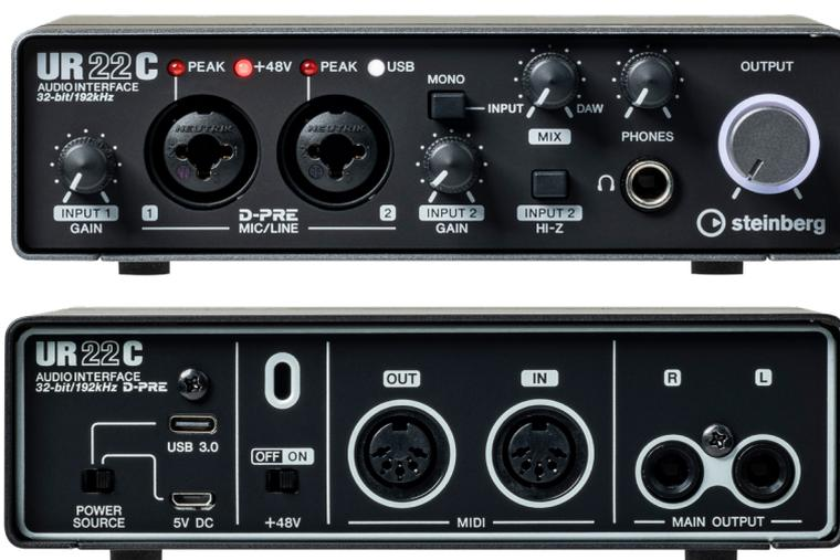
② Переместите переключатель Power Source вправо. Подключите источник питания ко входу 5V DC. Подойдет зарядка от телефона или внешнего аккумулятора. Используйте кабель micro usb.
