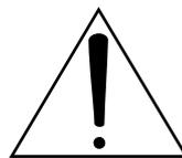
Восклицательный знак в равностороннем треугольнике предупреждает пользователя о наличии важных инструкций относительно работы и обслуживания устройства в сопутствующей литературе.
