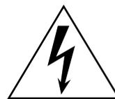
Молния со стрелкой в равностороннем треугольнике предупреждает пользователя о наличии неизолированного опасного электрического напряжения в корпусе устройства, которое может достигать достаточного значения для электрического удара.
