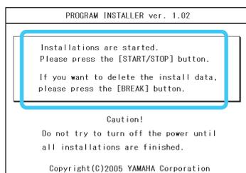
Drücken Sie den [START/STOP] Schalter um die Installation zu starten. Fahren Sie fort mit [Schritt 4](#) . (Ausführen der Installation).
