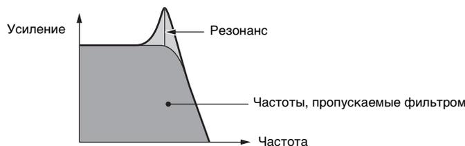
**LPF24A:** цифровой динамический фильтр низких частот с характеристиками, аналогичными характеристикам 4-полюсного аналогового фильтра синтезатора.
