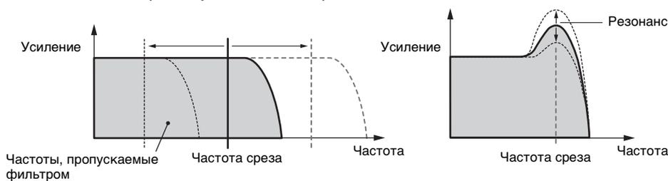
**LPF24D:** динамический фильтр низких частот (-24 дБ/окт.) с типовым цифровым звуковым сигналом. По сравнению с типом LPF24A этот фильтр может производить более выраженный резонансный эффект.
