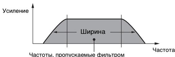
**BPF6:** комбинация фильтра низких частот и фильтра высоких частот (-6 дБ/окт.).
