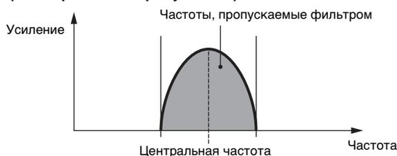
**BPF12D:** комбинация фильтра низких частот и фильтра высоких частот (-12 дБ/окт.) с цифровым звуком.
