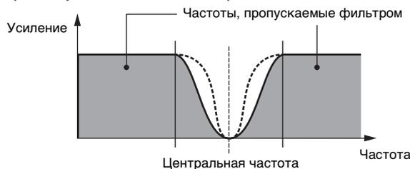
**BEF12:** фильтр подавления частот (-12 дБ/окт.).**BEF6:** фильтр подавления частот (-6 дБ/окт.).**DualLPF:** параллельно соединены два фильтра низких частот (-12 дБ/окт.). Предусмотрена возможность редактирования интервала между двумя частотами среза.
