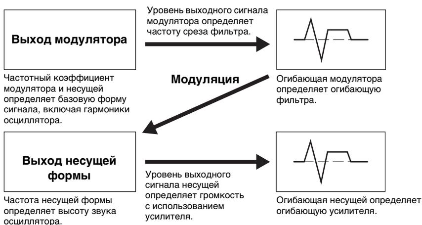
Хотя на представленном выше рисунке показаны формы сигнала, сгенерированные двумя операторами, MODX имеет восемь операторов. Комбинация ряда операторов называется «алгоритмом», и этот синтезатор поддерживает параметры для настройки алгоритма.
