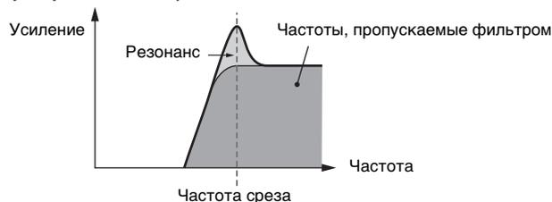
**LPF12 + HPF12:** комбинация фильтра низких частот (-12 дБ/окт.) и фильтра высоких частот (-12 дБ/окт.), подключенных последовательно. При выборе этого типа фильтра предусмотрена возможность установки значений параметров HPF Cutoff (Частота среза фильтра высоких частот) и HPF Key Follow Sensitivity (Чувствительность фильтра высоких частот для смежных клавиш).
