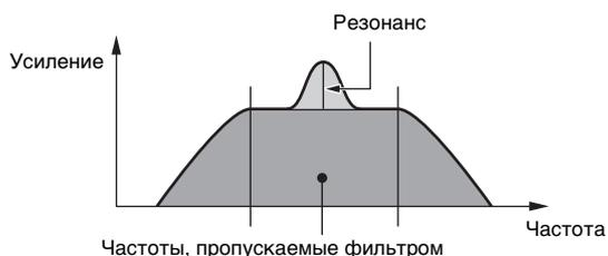
**BPFw:** BPF (-12 дБ/окт.) с комбинацией фильтра низких частот и фильтра высоких частот, обеспечивающей настройки более широкого частотного диапазона.
