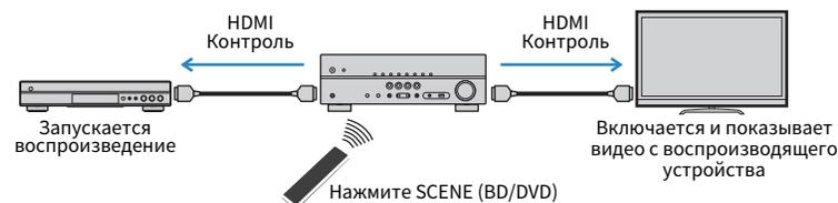
Для использования функции HDMI Контроль необходимо выполнить следующую настройку соединения HDMI Контроль после подключения телевизора и воспроизводящих устройств.
