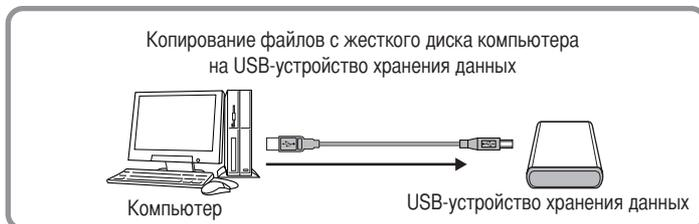
Отключите USB-устройство хранения данных от компьютера и подключите его к инструменту.
