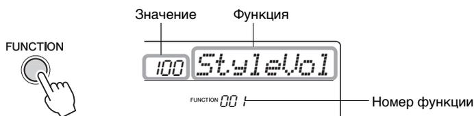
Если функция содержит подрежимы, эта функция отображается на экране несколько секунд, а затем отображаются подрежимы.
