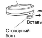
3. Ослабьте болты с A по C, как показано на рисунке, чтобы отрегулировать высоту и угол предназначенной для игры поверхности каждого пэда тома. Достигнув нужного положения, крепко затяните болты, прежде чем переходить к следующему шагу.
