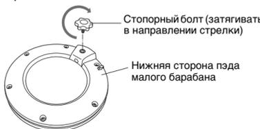
2. Вставьте пэд малого барабана в держатель малого барабана стойки. Убедитесь, что стержень держателя малого барабана полностью вставлен в крепежное отверстие, после чего затяните стопорный болт для фиксации пэда.
