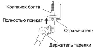
6. Установите одну из фетровых прокладок, снятых на шаге 2, на держатель тарелки.
