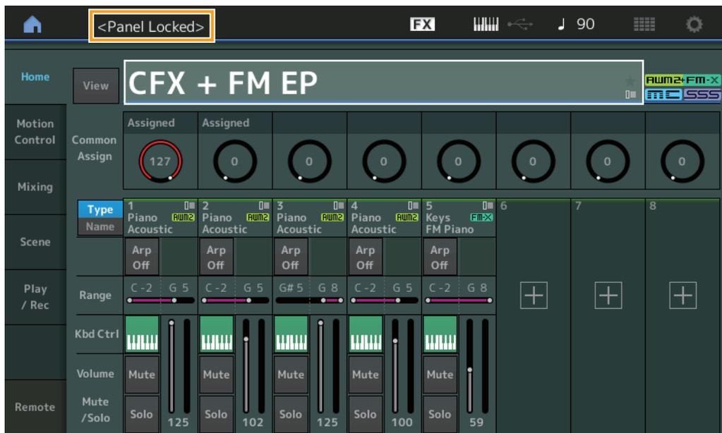
Чтобы разблокировать панель, снова нажмите клавиши [SHIFT] + [ELEMENT COMMON]. При включении функции блокировки панели все операции будут недоступны, кроме клавиатуры, педалей, общей громкости, регулятора Super Knob, регулятора высоты звука, колеса модуляции, ленточного контроллера и операции разблокировки. Эта блокировка также применяется к операциям на сенсорной панели.
