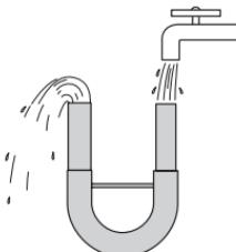
**Внимание!** При очистке внутренних частей педальной тубы никогда не разбирайте вентили. Также при промывке трубок водой пропускайте воду через настроечные кроны в направлении, противоположном потоку воздуха. Если пропускать воду через инструмент со стороны мундштучной трубы то загрязнения могут забить вентили, из-за чего они могут перестать работать.
