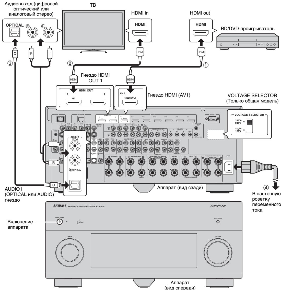
Перед подключением силового кабеля (только общие модели)
