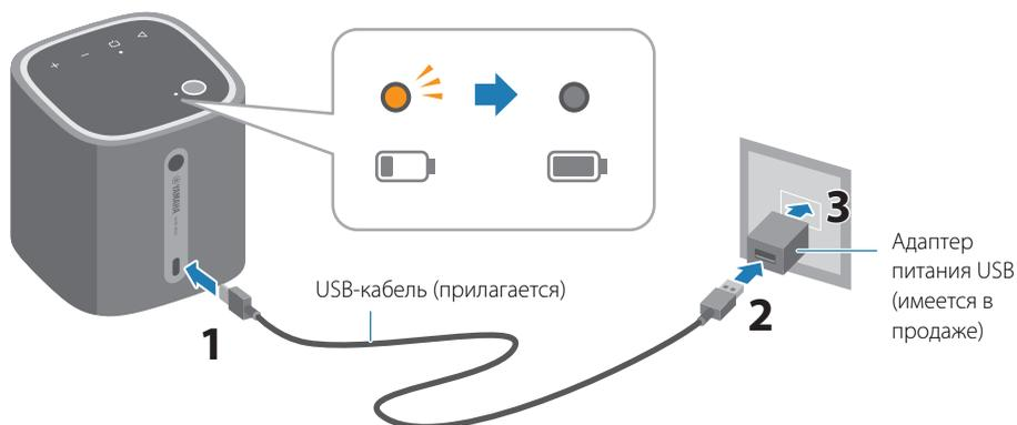
**1** Подсоедините разъем Type-C кабеля USB к порту USB на данном аппарате.
