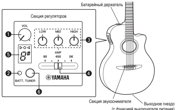
При подсоединении кабеля гитары к выходному гнезду автоматически включается встроенный предусилитель. Тюнер можно включить или выключить в любое время.
