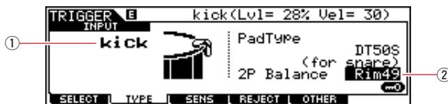
3. Выберите название разъема (1), используемого для подключения к электронному барабанному модулю, затем измените баланс (2).
