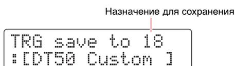
2. Поверните диск ввода данных для выбора номера конфигурации триггера пользователя (18–33), в которую следует сохранить настройки.
