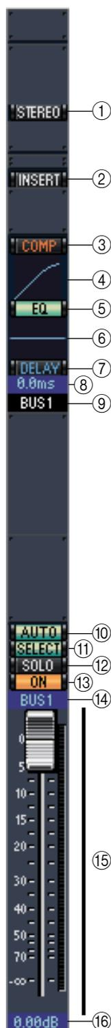
При нажатии на кнопку Master LAYER в главном окне отображаются каналы выходной шины и посылы по дополнительному порту. Каналы посылы по дополнительному порту выглядят так же, как и каналы выходной шины за исключением того, что в каналах выходной шины присутствует кнопка [STEREO].
