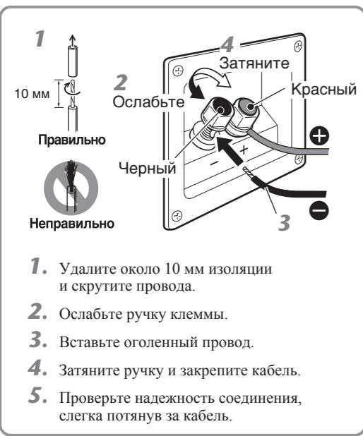
1. Удалите около 10 мм изоляции и скрутите провода.
