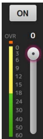
**4 Контролируя индикатор уровня выходного сигнала тактового генератора, перетащите ползунок уровня тактового генератора для регулировки уровня выходного сигнала тактового генератора.**
