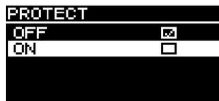
Установите для этого параметра значение ON, чтобы запретить перезапись (STORE), удаление (CLEAR) или изменение заголовков (TITLE) предустановок. Слева от заголовка предустановки на экране PRESET отобразится ключевая метка (стр. 13).
