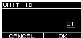
Поверните основной регулятор, чтобы выбрать нужный символ, а затем нажмите регулятор для его ввода. Когда отобразится экран подтверждения перезапуска, выберите YES. Настройка будет применена после перезапуска изделия.
