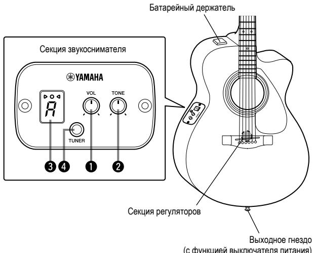
При подсоединении кабеля гитары к выходному гнезду автоматически включается встроенный предусилитель.
