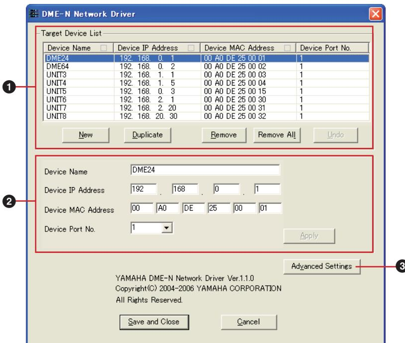
**ПРИМЕЧАНИЕ:** Чтобы можно было пользоваться сетевым драйвером DME-N, все сетевые компьютерные устройства (концентраторы-коммутаторы, маршрутизаторы и т.п.) должны быть правильно подсоединенны и настроены. Чтобы подсоединить M7CL к компьютеру напрямую, без использования каких-либо сетевых устройств, воспользуйтесь перекрестным кабелем.
