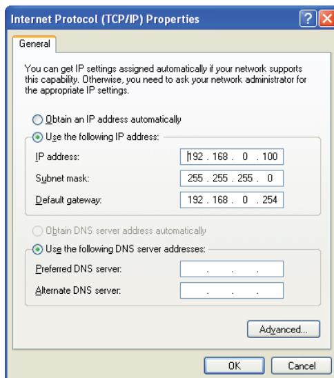
**ПРИМЕЧАНИЕ.** При установке в ту же подсеть, что и устройства DME, установите адрес шлюза 254.
