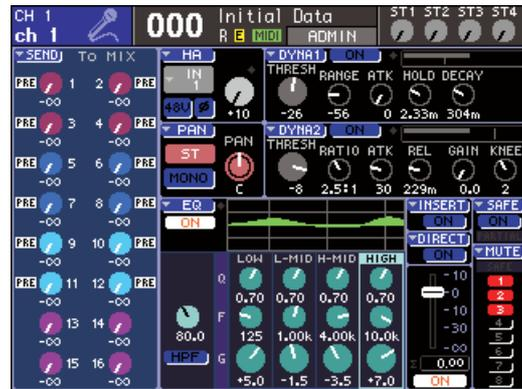
Выберите с помощью секции DISPLAY ACCESS (стр. 19) экран, который вы хотите просмотреть. Затем с помощью курсорных клавиш секции ввода данных (стр. 22), переместите курсор на нужный параметр и отредактируйте значение с помощью диска или клавиш [INC] [DEC].
