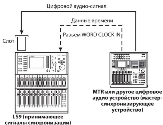
В любом случае, необходимо выполнить следующие действия, чтобы определить источник синхронизирующего сигнала, который будет использоваться микшером LS9.
