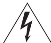
Значок молнии со стрелкой в равностороннем треугольнике предназначен для предупреждения пользователя о присутствии в корпусе продукта неизолированного «опасного напряжения», которое может вызвать опасный электрический удар.
