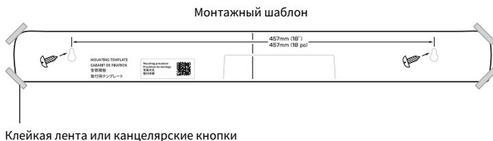
**2 Отметьте на стене положения для винтов с помощью карандаша.**
