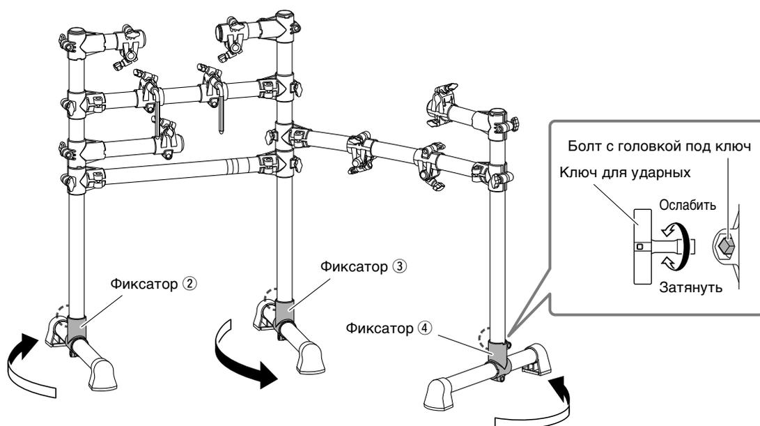
4. Сдвиньте основания ножек, чтобы отрегулировать положение.
