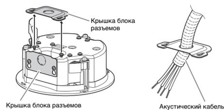
В крышках блоков разъемов нет отверстия для акустического кабеля. Прорежьте отверстие в крышке используемого блока разъемов (как показано на рисунке).
