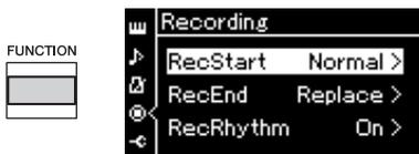
1-2. Кнопками [^]/[v] выберите пункт RecStart (Момент начала записи), а затем кнопкой [>] выберите вариант определения момента начала записи.
