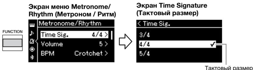
2. Выберите нужный тактовый размер при помощи кнопок [^]/[v].
