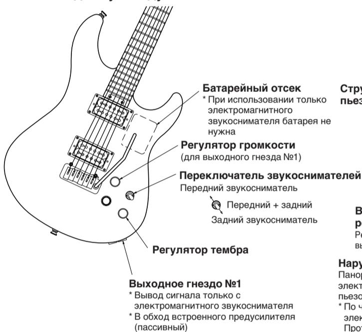
2. Чтобы использовать и электромагнитный, и пьезозвукосниматель, подключите шнур к выходному гнезду №2.
