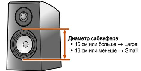
В случае установки размера колонки в положение "Small" низкочастотные компоненты настроенных колонок будут воспроизводиться через сабвуфер (или через фронтальные колонки, если сабвуфер отсутствует).
