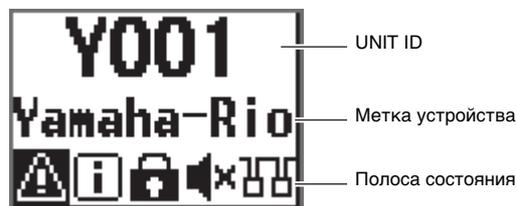
Это экран, который появляется при включении выключателя питания. В верхней строке отображается UNIT ID. Начальное значение составляет Y001. В среднем ряду отображается часть метки устройства. В нижнем ряду отображается строка состояния, в которой используются значки, обозначающие состояние модуля.
