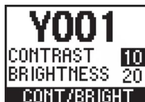
Этот экран позволяет настроить контрастность и яркость дисплея. Он также позволяет настроить яркость индикатора цветной полосы. Нажмите и удерживайте кнопку [↶] (Назад), чтобы отобразить его.
