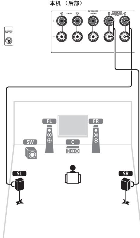
**4 将低音炮 (SW) 连接至 SUBWOOFER PRE OUT 插孔。**
