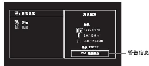
① 检查前面板显示屏的指示器的闪烁情况以确定有问题的音箱。
