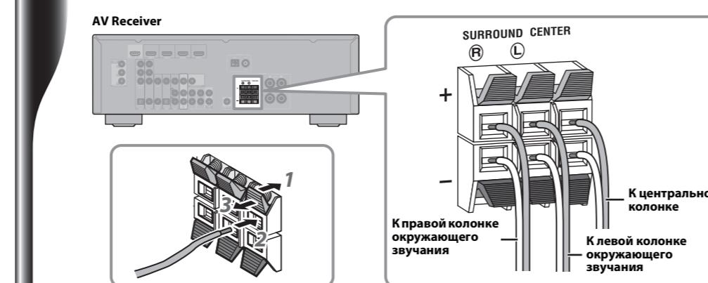
С помощью кабелей соедините центральную колонку ((G)), колонку окружающего звучания ((F)) и AV Receiver. Убедитесь в том, что при подключении колонок была соблюдена правильная полярность—положительные (+) терминалы к положительным (+) терминалам, а отрицательные (-) терминалы к отрицательным (-) терминалам.
