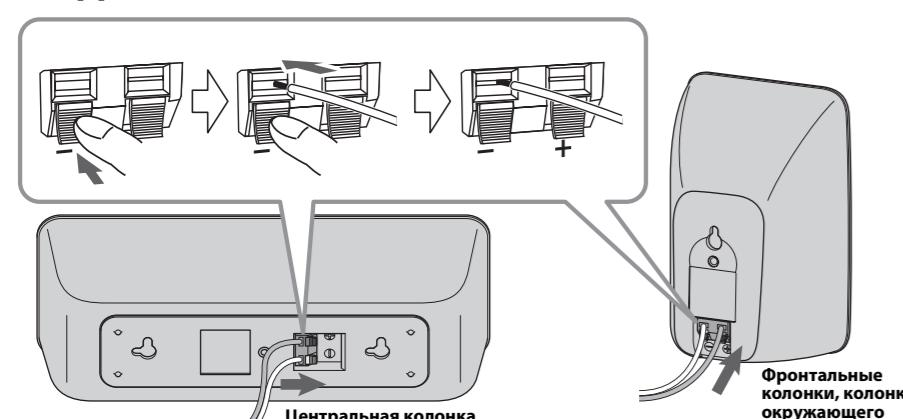
Порежьте прилагаемый кабель колонок на отрезки необходимой длины для центральной, фронтальных колонок и колонок окружающего звучания. В общей сложности у Вас должно получиться пять кабелей. Удалите изоляцию примерно на 10 мм на конце каждого кабеля, а затем плотно сплетите оголенные жилы.
