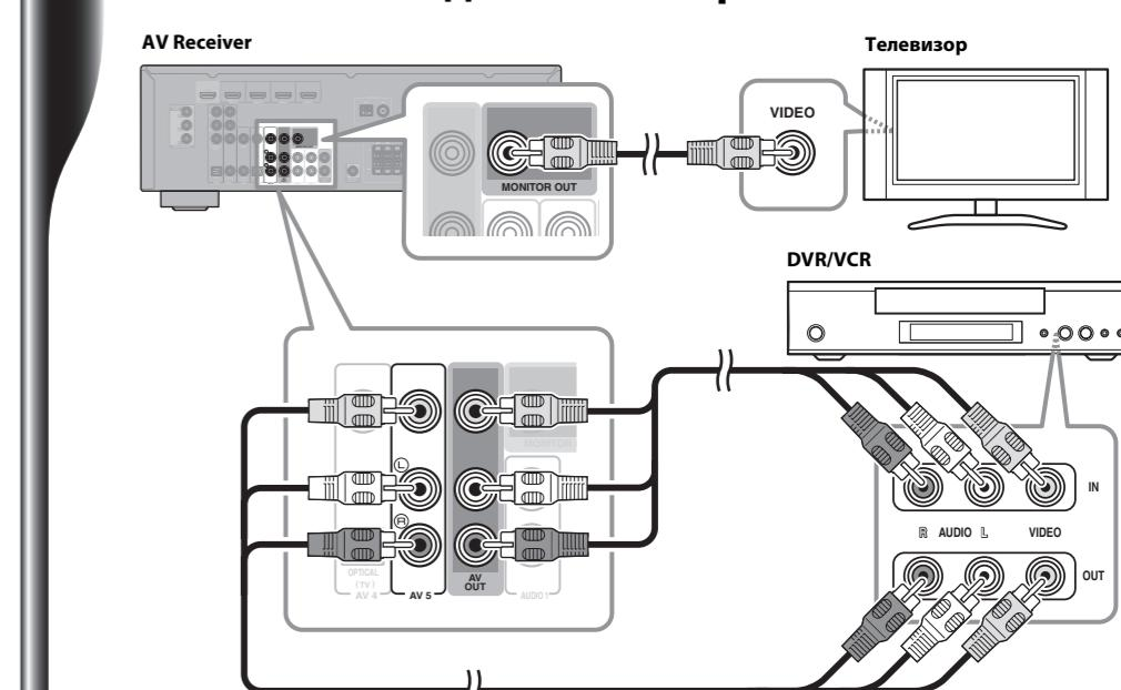
Подключите штыревой видеокабель (не включен в комплект поставки) к гнезду MONITOR OUT на AV Receiver и композитному видеовходу на телевизоре, как показано на рисунке.
