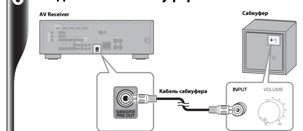
С помощью прилагаемого кабеля для сабвуфера ((I)) соедините гнездо INPUT сабвуфера и гнездо AV Receiver SUBWOOFER PRE OUT.
