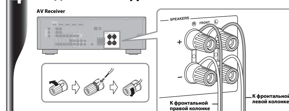
Подключите кабели фронтальной колонки ((F)) к гнездам AV Receiver. Убедитесь в том, что при подключении колонок была соблюдена правильная полярность—положительные (+) терминалы к положительным (+) терминалам, а отрицательные (-) терминалы к отрицательным (-) терминалам.
