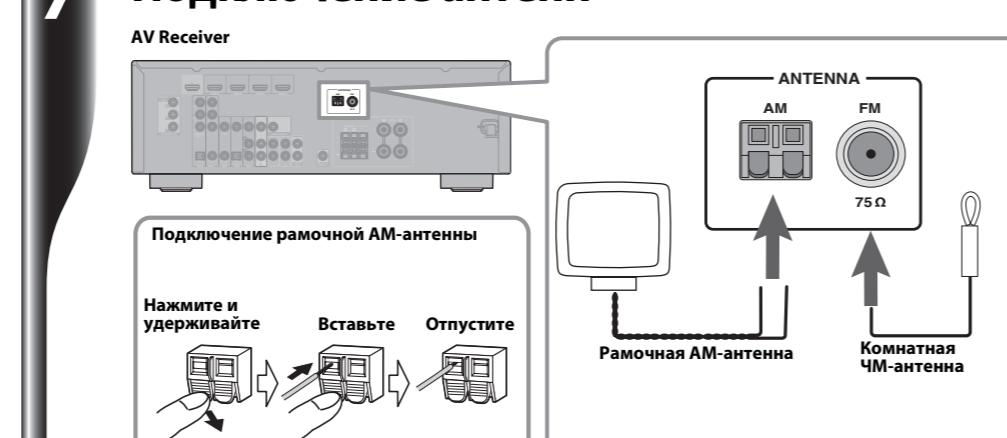
Подключите рамочную АМ-антенну ((C)) и комнатную ЧМ-антенну ((D)) к гнездам на AV Receiver, как показано на рисунке. Для получения более подробной информации о подключении антенн обратитесь к руководствам пользователя.
