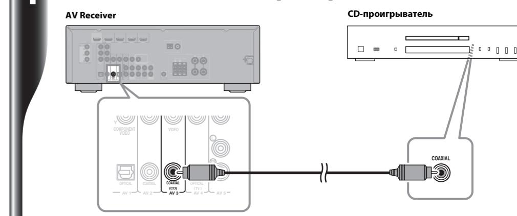
Подключите цифровой коаксиальный кабель (не включен в комплект поставки) к CD-проигрывателю и гнезду AV Receiver AV 3 COAXIAL(CD), как показано на рисунке.
