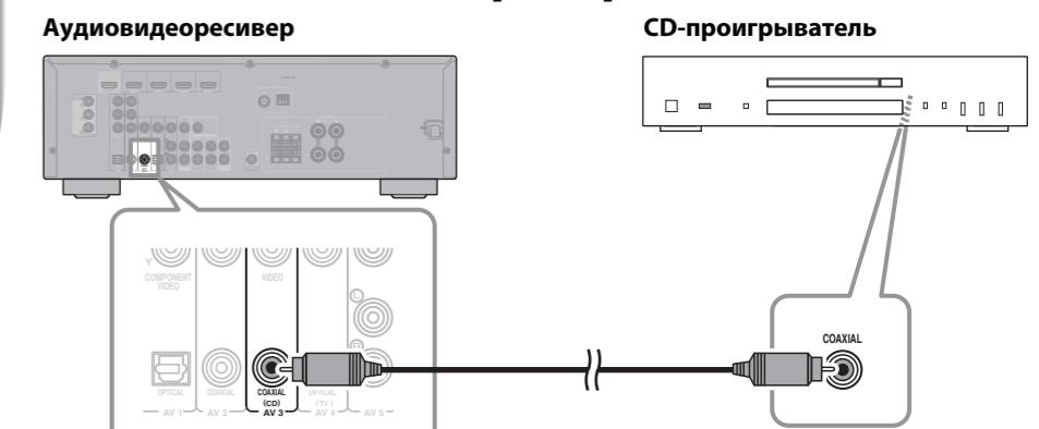
Подключите штыревой аудиокабель (не включен в комплект поставки) к CD-проигрывателю и гнездам Аудиовидеоресивер AV 3 COAXIAL(CD), как показано на рисунке.
