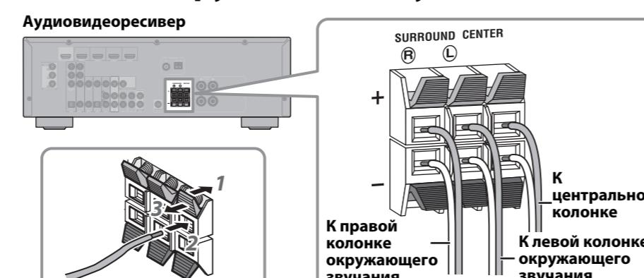
Подключите кабеля центральной колонки (H) и колонок окружающего звучания (G) к Аудиовидеоресиверу. Убедитесь в том, что при подключении колонок была соблюдена правильная полярность—положительные (+) терминалы к положительным (+) терминалам, а отрицательные (-) терминалы к отрицательным (-) терминалам.
