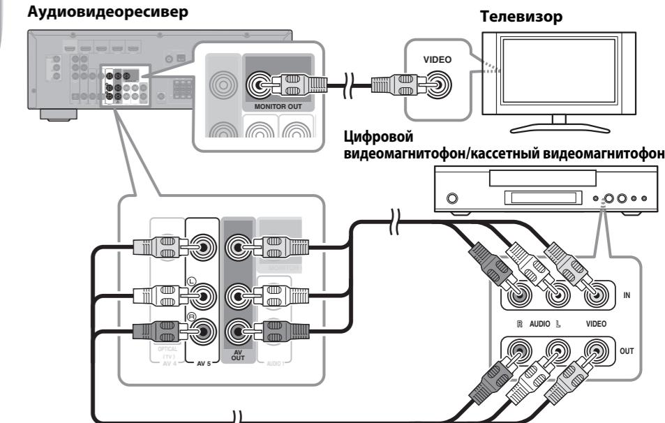
Подключите штыревой видеокабель (не включен в комплект поставки) к гнезду MONITOR OUT на Аудиовидеоресивере и композитному видеовходу на телевизоре, как показано на рисунке.
