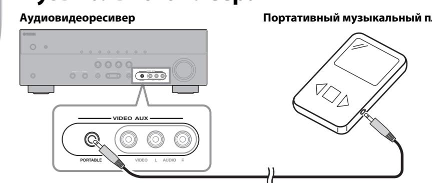
Подключите 3,5-мм стереокабель с миништекером (не включен в комплект поставки) к портативному музыкальному плееру и гнезду Аудиовидеоресивер PORTABLE (на передней панели), как показано на рисунке.
