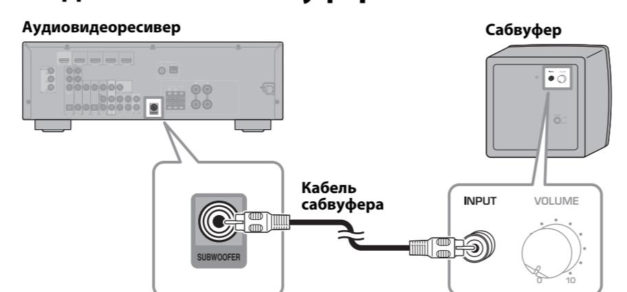
С помощью прилагаемого кабеля для сабвуфера (J) соедините гнездо INPUT на сабвуфере и гнездо Аудиовидеоресивер SUBWOOFER.
