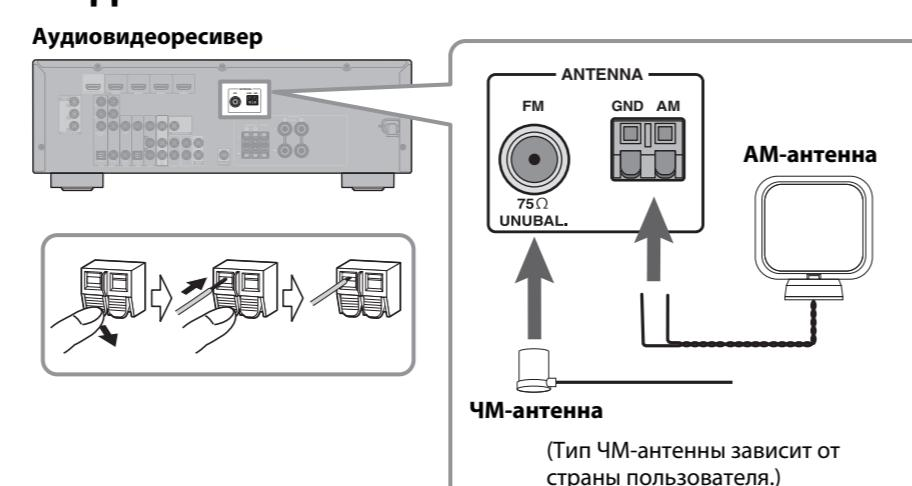
Подключите рамочную АМ-антенну (D) и комнатную ЧМ-антенну (E) к Аудиовидеоресиверу, как показано на рисунке. Для получения более подробной информации о подключении антенн обратитесь к руководствам пользователя.
