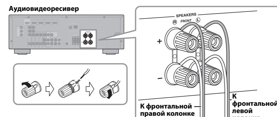
Подключите кабели передних колонок (G) к аудиовидеоресиверу. Убедитесь в том, что при подключении колонок была соблюдена правильная полярность—положительные (+) терминалы к положительным (+) терминалам, а отрицательные (-) терминалы к отрицательным (-) терминалам.
