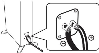
Убедитесь в правильном подключении “+” (красный) и “-” (черный). Провода отличаются цветом или формой, например, один может быть отмечен полосками, углублениями или складками. Подключите провод с полосками (углублениями и т.д.) к терминалам “+” (красный) данного аппарата и колонки. Подключите гладкий провод к терминалам “-” (черный).
