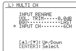
Если подключенный компонент выводит дискретные 6-канальные аудиосигналы. Выберите “6CH”.
