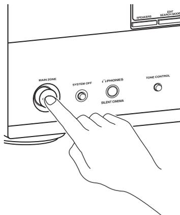
Данный аппарат устанавливается на режим ожидания и потребляет малое количество электроэнергии для приема инфракрасных сигналов от пульта ДУ. Для включения данного аппарата от режима ожидания, нажмите нужные кнопки **Ⓢ SCENE** (или **Ⓓ SCENE**) или **Ⓚ MAIN ZONE ON/OFF** (или **Ⓟ POWER**). Смотрите стр. 29 для более подробной информации.
