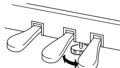
Поворачивайте регулятор высоты до тех пор, пока он не придет в тесный контакт с поверхностью пола.
