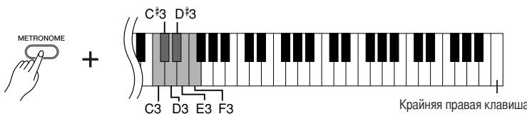
Клавиша C3: без сильных долей такта, клавиша C#3: 2/4, клавиша D3: 3/4, клавиша D#3: 4/4, клавиша E3: 5/4, Клавиша F3: 6/4
