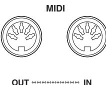
Поскольку передача и прием данных MIDI может различаться в зависимости от типа устройства MIDI, каждое устройство MIDI может передавать и получать только данные и команды, совместимые с другими подключеннымми устройствами MIDI. Чтобы узнать, передача и прием каких данных и команд поддерживаются используемыми устройствами, обратитесь к таблице характеристик MIDI-интерфейса в Интернете (см. «Сборник таблиц» на стр. 6).
