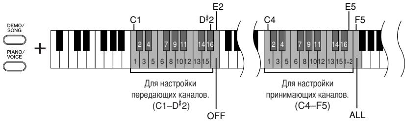
В режиме наложения тембров данные тембра Voice 1 передаются по специально указанному каналу, а данные тембра Voice 2 передаются по каналу, номер которого больше номера этого канала. Если в этом режиме передающий канал установлен в положение OFF, данные не передаются.
