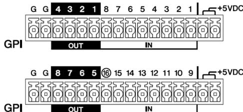
DME7 имеет 16 входных контактов и 8 выходных контактов.
