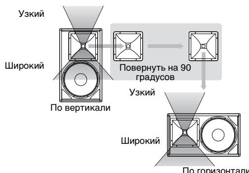
**ПРИМЕЧАНИЕ** Если динамик используется как напольный монитор, измените дисперсию рупора так, чтобы распространение вверх было широким, а распространение вниз — узким, как показано на схеме.
