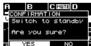
2. С помощью основного регулятора выберите вариант YES (ДА), затем нажмите основной регулятор для подтверждения. Устройство перейдет в режим ожидания.
