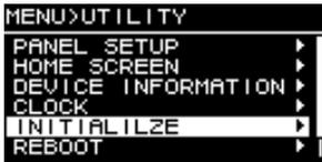
2. На экране UTILITY поверните основной регулятор для выбора INITIALIZE и нажмите основной регулятор для подтверждения.
