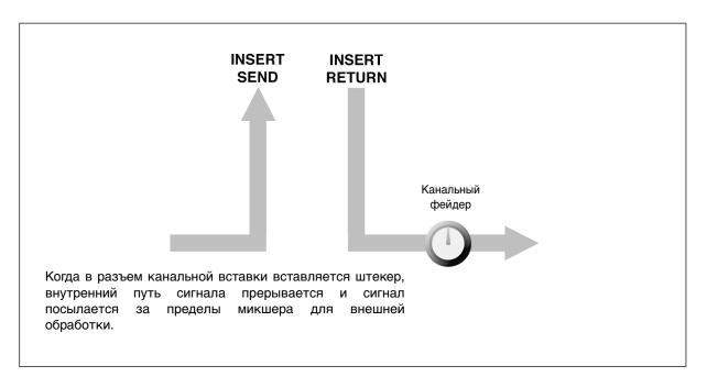
Разъемы канальных вставок должны использоваться со специальным кабелем, имеющим штекерный TRS-разъем на одном конце и штекерные Y-образные расщепленные моноразъемы на другом. Один из штекерных моноразъемов переносит сигнал посыла, который необходимо подать на вход внешнего процессора, а другой — сигнал возврата с выхода процессора.
