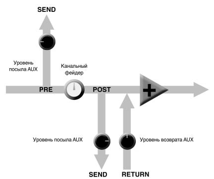
**Посыл «после фейдера» для внешней обработки эффектов.** Сигнал посыла подается на внешнее устройство эффектов (например на ревербератор), а выходной сигнал возвращается на разъем AUX Return и снова смешивается с основным материалом. Канальный фейдер влияет на уровень посыла, поэтому уровень эффекта всегда пропорционален сигналу канала.
