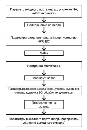
Выполняйте настройки для нужных компонентов в автономном режиме (без подключения к сети).
