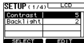
2. Поверните регулятор 1, чтобы выбрать элемент «Contrast», а затем поверните регулятор 2, чтобы отрегулировать четкость дисплея.
