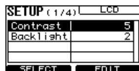
2. Поверните регулятор 1, чтобы выбрать элемент «Backlight», а затем поверните регулятор 2, чтобы отрегулировать яркость.
