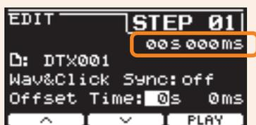
**3-3.** Установите отобразившееся время в качестве значения параметра *Offset Time* (Время смещения).
