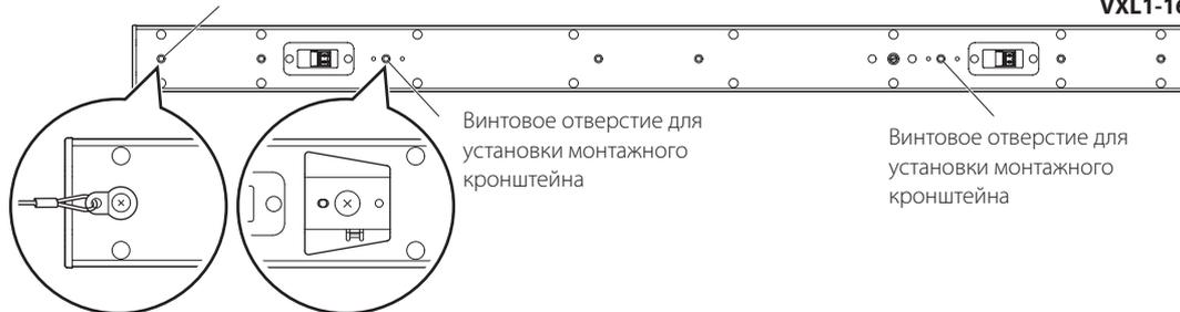
Винтовое отверстие для установки предохранительной проволоки
