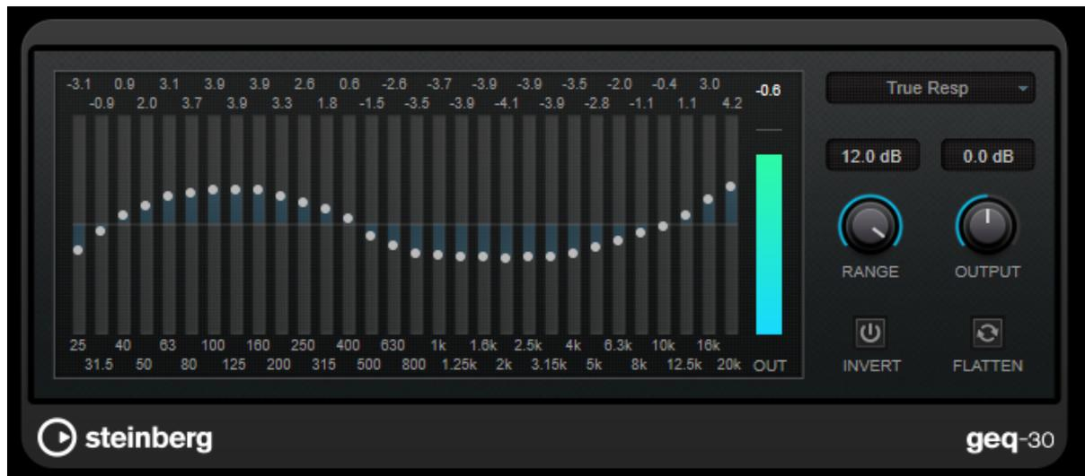
Каждая полоса может быть ослаблена или усилена на 12 дБ, что позволяет точно контролировать частотную характеристику. Кроме того, доступно несколько предустановленных режимов, которые могут добавить окраску к звуку GEQ-30.
