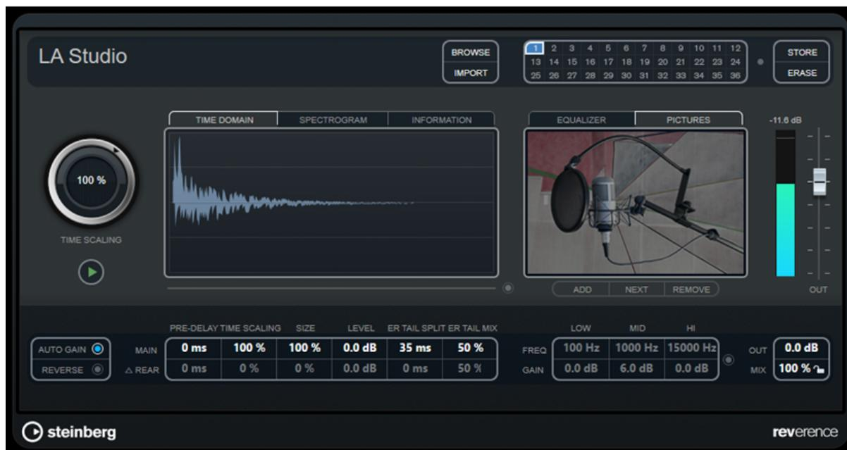
Это делается путем обработки звукового сигнала с помощью импульсного отклика - записи импульсного сигнала, сделанной в помещении или другом месте, которая воссоздает характеристики помещения. В результате обработанный аудио материал звучит так, как будто проигрывается в том же помещении. С плагином поставляются высококачественные семплы реально существующих пространств/залов, позволяющие создать качественную реверберацию.
