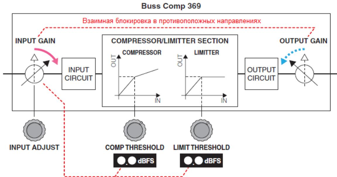
Так как значение порога срабатывания изменяется существенно, отображаемая величина изменится вместе с ним. Однако, внутренне состояние секции COMPRESSOR/LIMITER (Компрессор/Лимитер) SECTION не изменяется.
