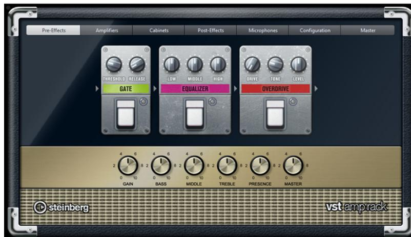
В верхней части панели плагина находятся семь кнопок, которые упорядочены в соответствии с расположением соответствующих элементов в последовательности сигнала. Каждая кнопка открывает отдельную страницу в демонстрационной области панели плагина ([Pre-Effects] (Пре-эффект), [Amplifiers] (Усилители), [Cabinets] (Кабинеты), [Post-Effects] (Пост-эффект), [Microphone] (Микрофон), [Configuration] (Конфигурация) и [Master] (Мастер-устройство)).
