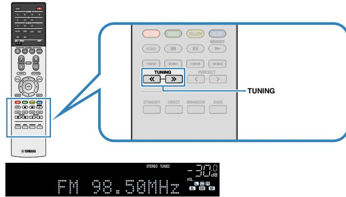
“TUNED” загорается на дисплее передней панели при приеме аппаратом сигнала радиостанции FM/AM.
