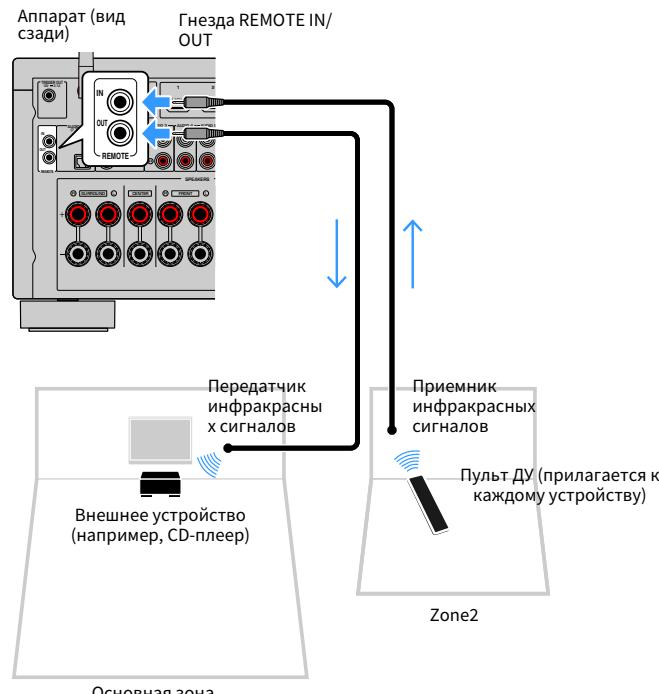
Если используются устройства Yamaha, которые, как и данный аппарат, поддерживают удаленные подключения, передатчик инфракрасных сигналов не требуется. Сигналы пульта ДУ можно передавать, соединив гнезда REMOTE IN/OUT с помощью монофонических аналоговых мини-кабелей и используя приемник инфракрасных сигналов.
