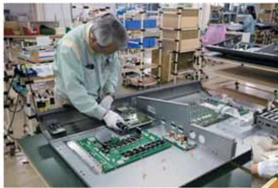
Монтаж печатных плат (Тоёка, Япония)
