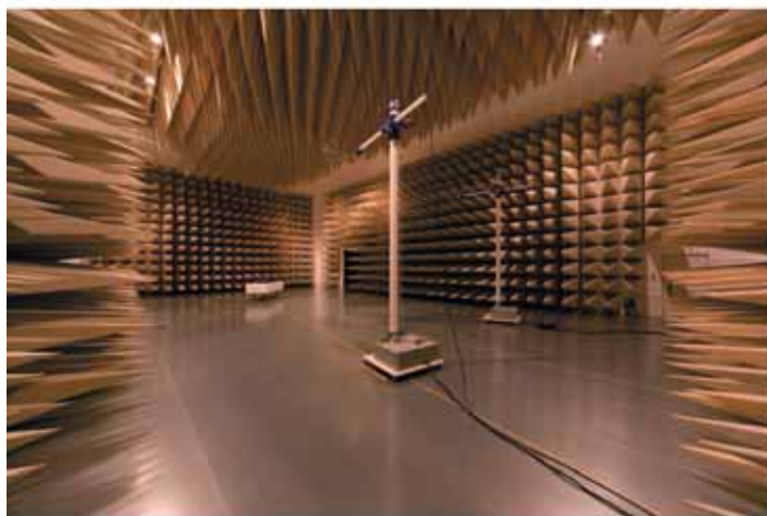
Большая камера для испытания на электромагнитную совместимость
