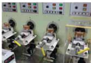
Испытание энкодеров на долговечность
