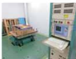
Вибрационный стенд, управляемый компьютером
