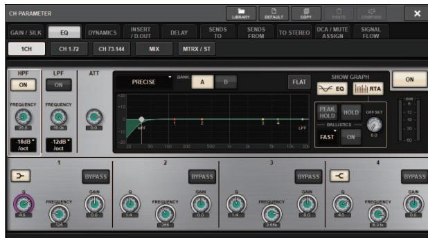
При необходимости переключение между всплывающими окнами производится с помощью вкладок. В верхней части некоторых всплывающих окон отображаются несколько кнопок, называемых «кнопками инструментов». Эти кнопки инструментов служат для вызова библиотек или выполнения операций копирования и вставки.
